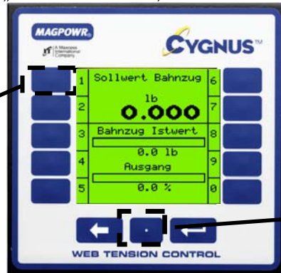
Eingabe Sollwert Bahnzug (Taste „Sollwert“ drücken, um in dieses Menü zu gelangen)
